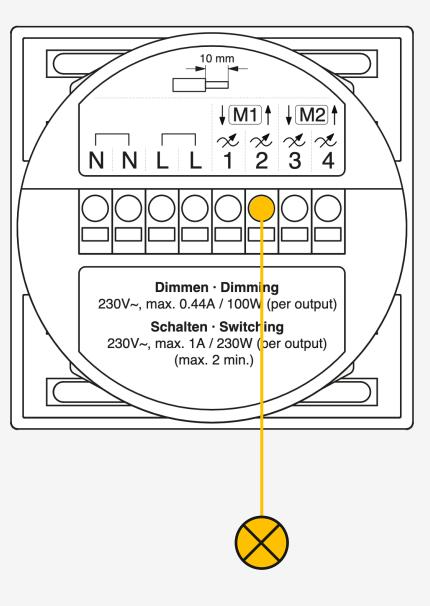
Anschluss für DALI immer mit 2 Drähten führen. Dadurch wird ermöglicht zu einem späteren Zeitpunkt die bestehende Base mit einer DALI Base zu ersetzen.
